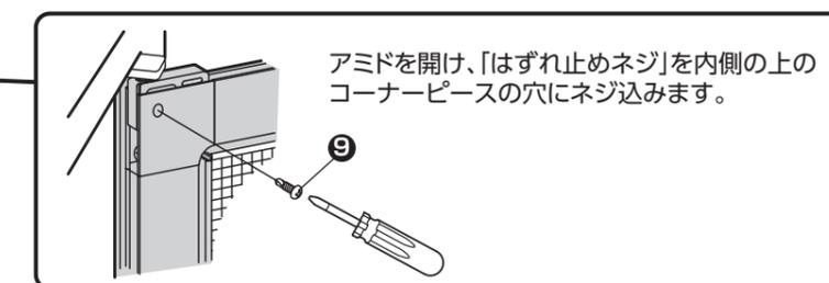
中のプラスチック部品には穴があいてないので、「はずれ止めネジ」を強くねじ込んで穴をあけ固定ください。ネジが斜めに入らないよう注意してください。
