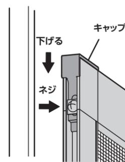
② 下のロック側コーナースタンプのネジをいったんゆるめ、キャップを「アミド受け」にわずかにこする程度まで下げます。再びネジで固定してください。(アミドが自重で傾いてくるのを防ぎます)
