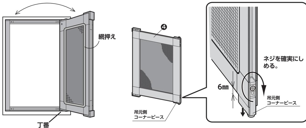
① ④網戸本体の吊元側コーナースタンプ(下)側面のネジをゆるめて、丁番を6mm出します。次に、ネジをしっかり締めて固定してください。
